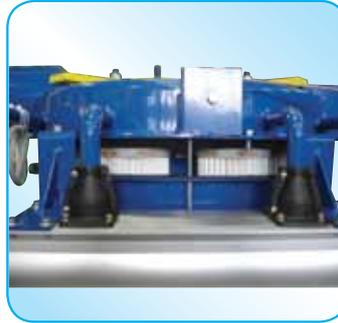
Décolmatage pneumatique des éléments filtrants et ré-introduction des fines via le conduit du double soufflets dédié au dépoussiérage.
