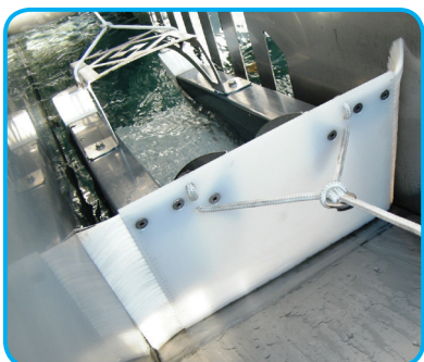
Selbstjustierender Fettschaber (entfernt Fett aber kein Wasser)
