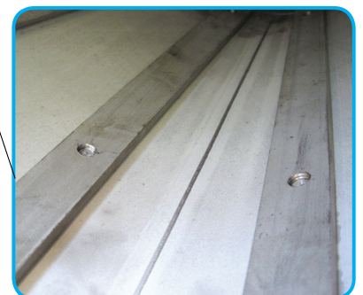
Verschraubte Schleifschienen (Innenansicht des Trogs)
